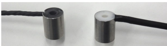
左側が LVDT、右側がデジタルセンサである。
