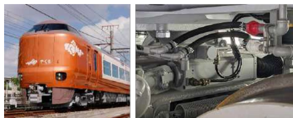
図4 273系振子電車と振子アクチュエータ
